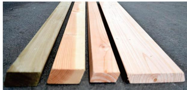
Douglasien - Kanthölzer genutet mit Rhombusleisten. Ab Feldbreite 100 cm empfehlen wir ein oder zwei Senkrechtleisten 25/67 mm hinter die Rhombusleisten zu schrauben, um ein Verziehen zu verhindern.
